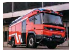
▲ EVポンプ車
