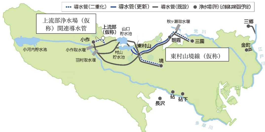
< 導水施設の二重化・更新 >
